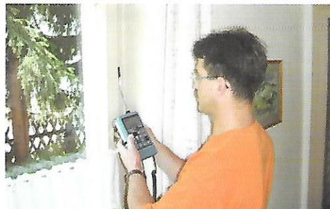
Luftstrommessung mit Anemometer
